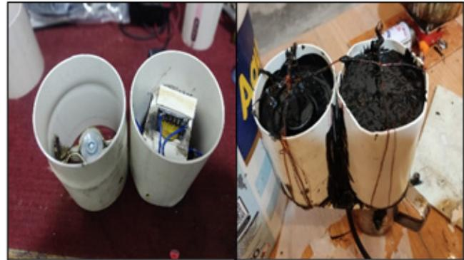
Gambar 15. Pengecoran sensor dan trafo
