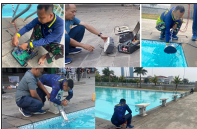
Gambar 15. Percobaan sensor receiver (Rx) bersamaan dengan sensor transmitter (Tx) USBL di kolam renang Kolat Armada RI.
