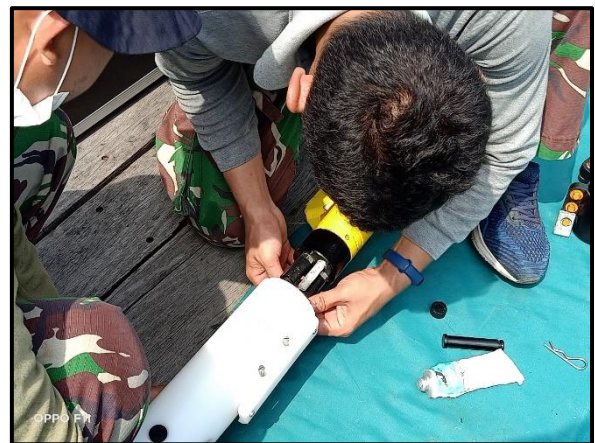
Gambar 5. Pemasangan Cable Tow Pada Head Fish Magneto .
