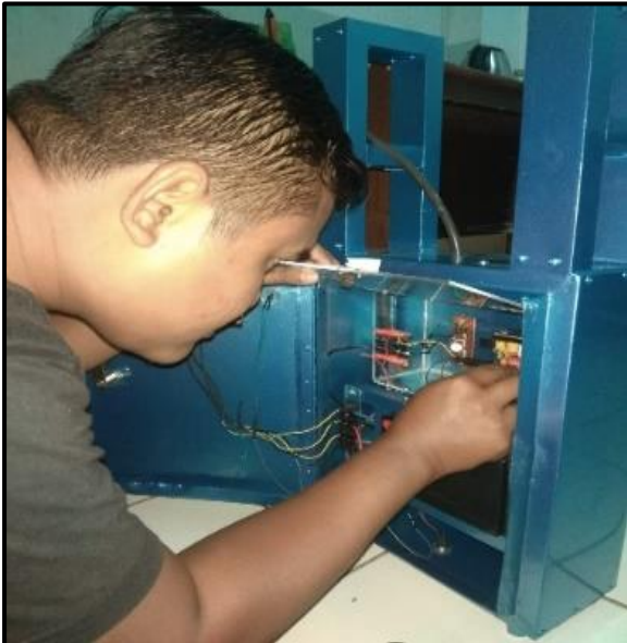
Gambar 9. Menghubungkan kabel jumper ke Arduino.
