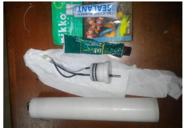
Dengan hasil uji coba *casing*, alat siap untuk uji coba di laut dengan membandingkan data yang dihasilkan oleh alat purwarupa gelombang dengan alat RBR DUO dan Tide Master yang telah diukur pada saat waktu dan tempat yang bersamaan. Apakah dapat bekerja sesuai yang diharapkan atau tidak.
