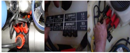
Memasang konektor sensor
