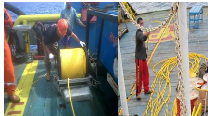
Salah satu penanganan umbilical saat ROV beroperasi
