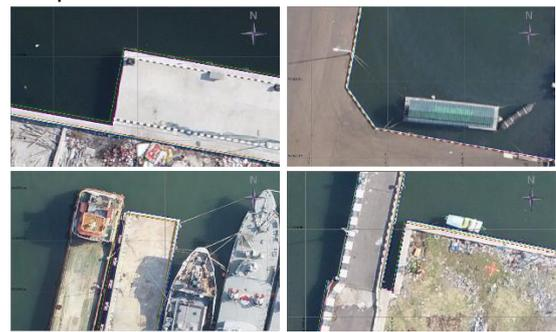
**Gambar 34.** Sampel Perbandingan *Vertice Line* (Merah: GNSS RTK, Hijau: Foto Udara Terektifikasi GCP, Biru: Foto Udara PPK, Oranye: Foto Udara PPK+1GCP) dengan *Overlay Orthomosaic PPK*.
