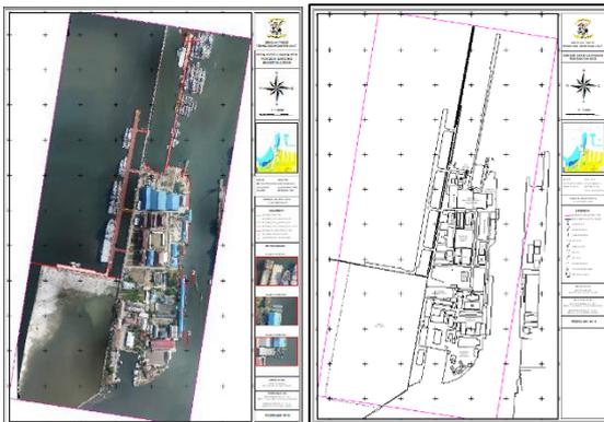
**Gambar 36.** *Layout* Peta Foto Udara PPK Dengan *Overlay* Pengukuran Garis Pantai Metode GNSS RTK (Kiri) Dan *Layout* Lembar Lukis Lapangan Pondok Dayung (Kanan).
