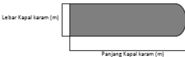
Estimasi dimensi *wreck* dengan menggunakan *tool measure distance* pada software *caris hips & ships* dengan cara menandai target terlebih dahulu, setelah itu dengan menggunakan *tool* kita ukur target tersebut panjang dan lebarnya. Selain itu estimasi dimensi dilakukan dengan menggunakan *tool digitize profile* untuk melihat penampakan profil dari target tersebut.
